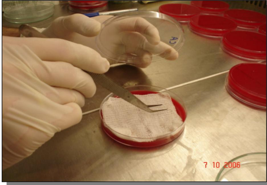
**Figura 2:** Exposição da gaze contaminada à placa de Ágar sangue, após a exposição à radiação de microondas em diferentes tempos ou autoclave.
