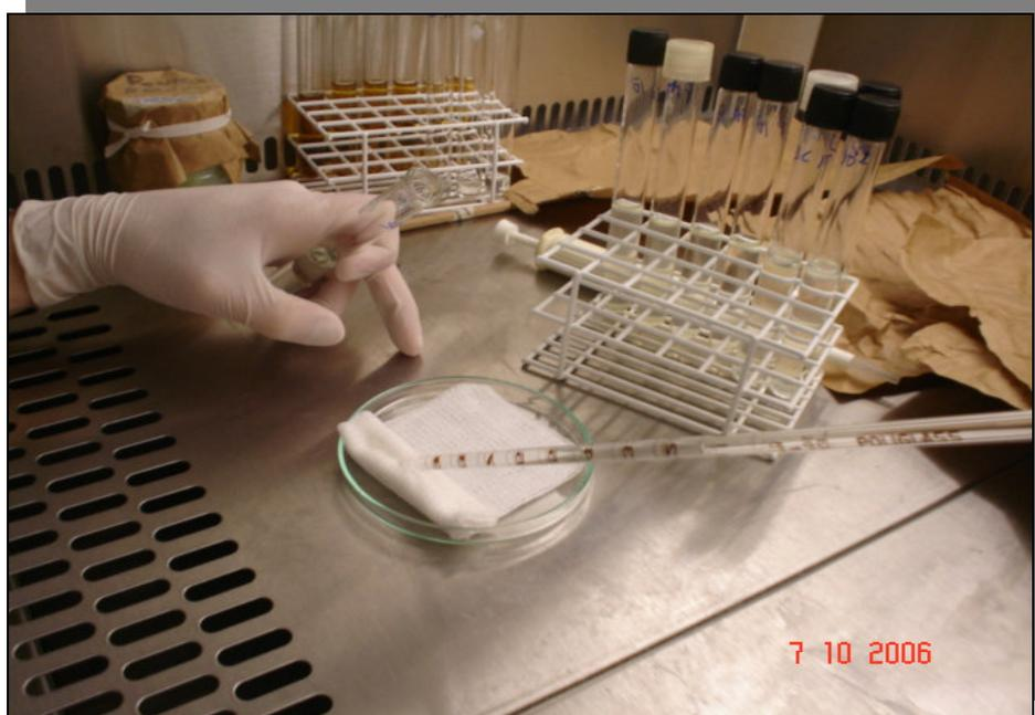
**Figura 1:** Contaminação das gazes com suspensão de microrganismos
